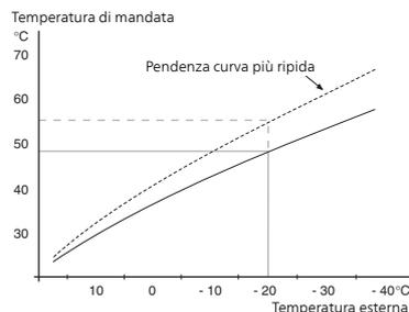
La pendenza ottimale dipende dalle condizioni climatiche del posto, dalla presenza o meno di radiatori o di riscaldamento a pavimento nell'abitazione e dal grado di isolamento dell'abitazione.
