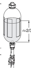
Se la pressione nell'impianto deve essere aumentata, ciò viene fatto chiudendo la valvola sulla tubatura principale in ingresso quando la pompa del glicole (GP2) è in funzione e il vaso di livello (CM2) è aperto, in modo che il liquido scorra dal vaso.
