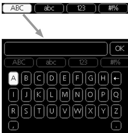
A seconda del menu, è possibile accedere a vari set di caratteri selezionabili mediante la manopola di controllo. Per cambiare set di caratteri, premere il pulsante indietro. Se all'interno di un menu è disponibile un solo set di caratteri, viene immediatamente visualizzata la tastiera.
