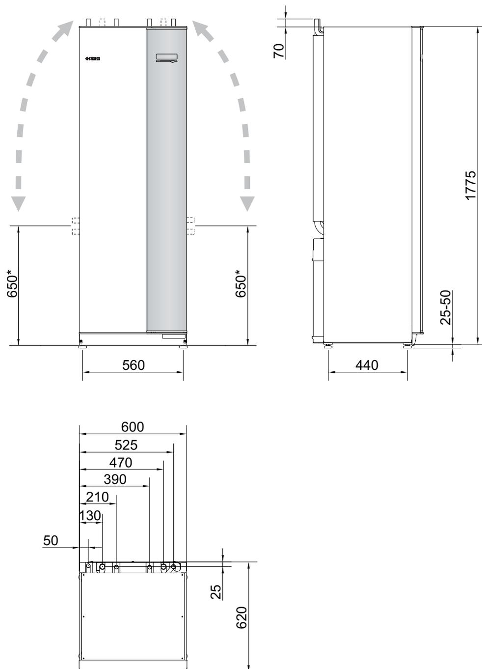
\* Questa dimensione riguarda i tubi del glicole a 90° (attacco laterale). La dimensione può variare di circa  $\pm 100$  mm in altezza poiché i tubi del glicole sono costituiti in parte da tubi flessibili.
